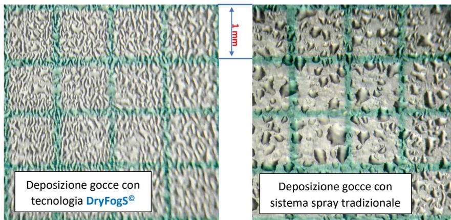
La dimensione stabile delle microgocce generate dal Sistema DryFogS®, non avendo deriva per effetto della polarizzazione delle stesse, contrariamente a quelle generate dai tradizionali Nebulizzatori, non si agglomerano in gocce di maggiori dimensioni, rimangono in sospensione nell'aria a lungo e si distribuiscono autonomamente in ogni fessura dei prodotti; **il risultato che ne deriva è una deposizione omogenea e duratura dell'attività desiderata sulle superfici.**
