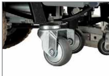
Le 2 ruote pivotanti sotto lo chassis garantiscono la massima manovrabilità a Freccia 30, garantendo allo stesso tempo il suo completo controllo sia in lavoro che in trasporto
