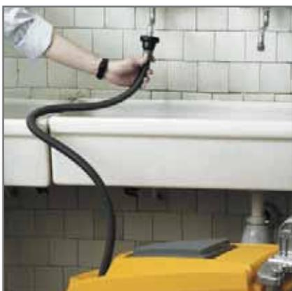
Il serbatoio soluzione può essere riempito velocemente grazie all'ampia "bocca" di carico e al pratico tubo di riempimento in dotazione
