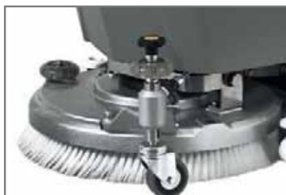
... mentre il pratico ruotino esterno permette di regolare la testata in altezza, in base al tipo di superficie di lavoro. Perfetto anche nella posizione di parcheggio.
